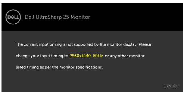
To znači da se monitor ne može sinkronizirati sa signalom koji prima s računala. Pogledajte [Monitor Specifications \(Tehnički podaci monitora\)](#) u vezi raspona horizontalne i vertikalne frekvencije koji se odnose na ovaj monitor. Preporučeni način rada je 2560 x 1440.
